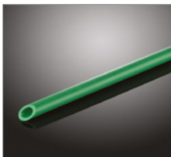
Materiale: Fusiolen® PP-R Normativa: DIN 8077/78 Certificati: DVGW DW-8501 AS2120/AU2224 Colore: verde Applicazione: idrico-sanitario, riscaldamento
